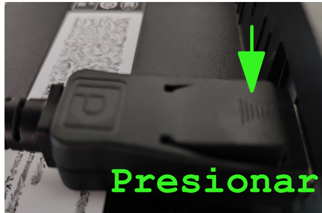
Figura 4: Pestaña de liberación en conector DisplayPort.
